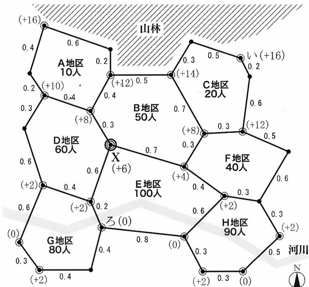
課題1：地点Xから地点「い」まで主要な道路を使って移動する場合の最短の距離を求なさい。また、災害時にこの距離を避難する際、避難者は初速度  $V_0=6$  (km/h) で逃げ始めるが、移動距離  $s$  (km) が増すごとに速度が低下し、
